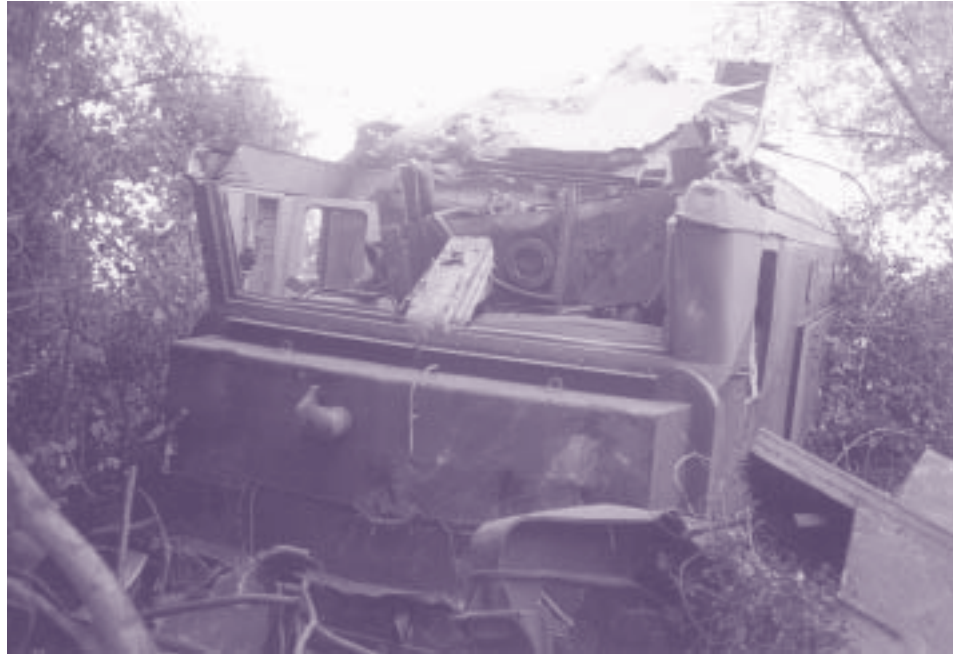
Čelna kabina brez strehe v katero je zarit del sklepnega vagona.
